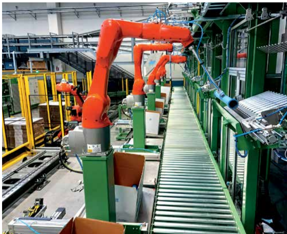
Sistema automatico di imballaggio tubi
